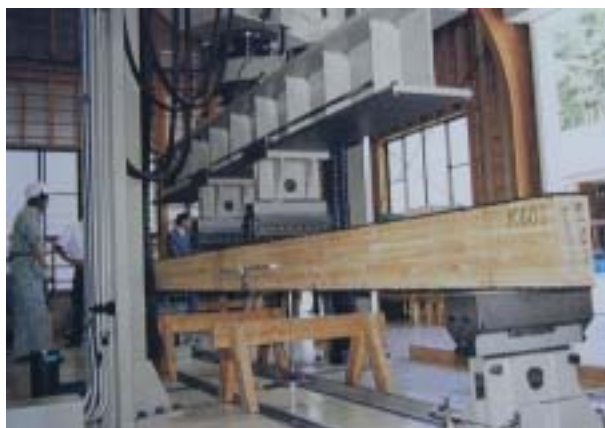
－集成材の強度試験－ (長野県林業総合センターHPより)
