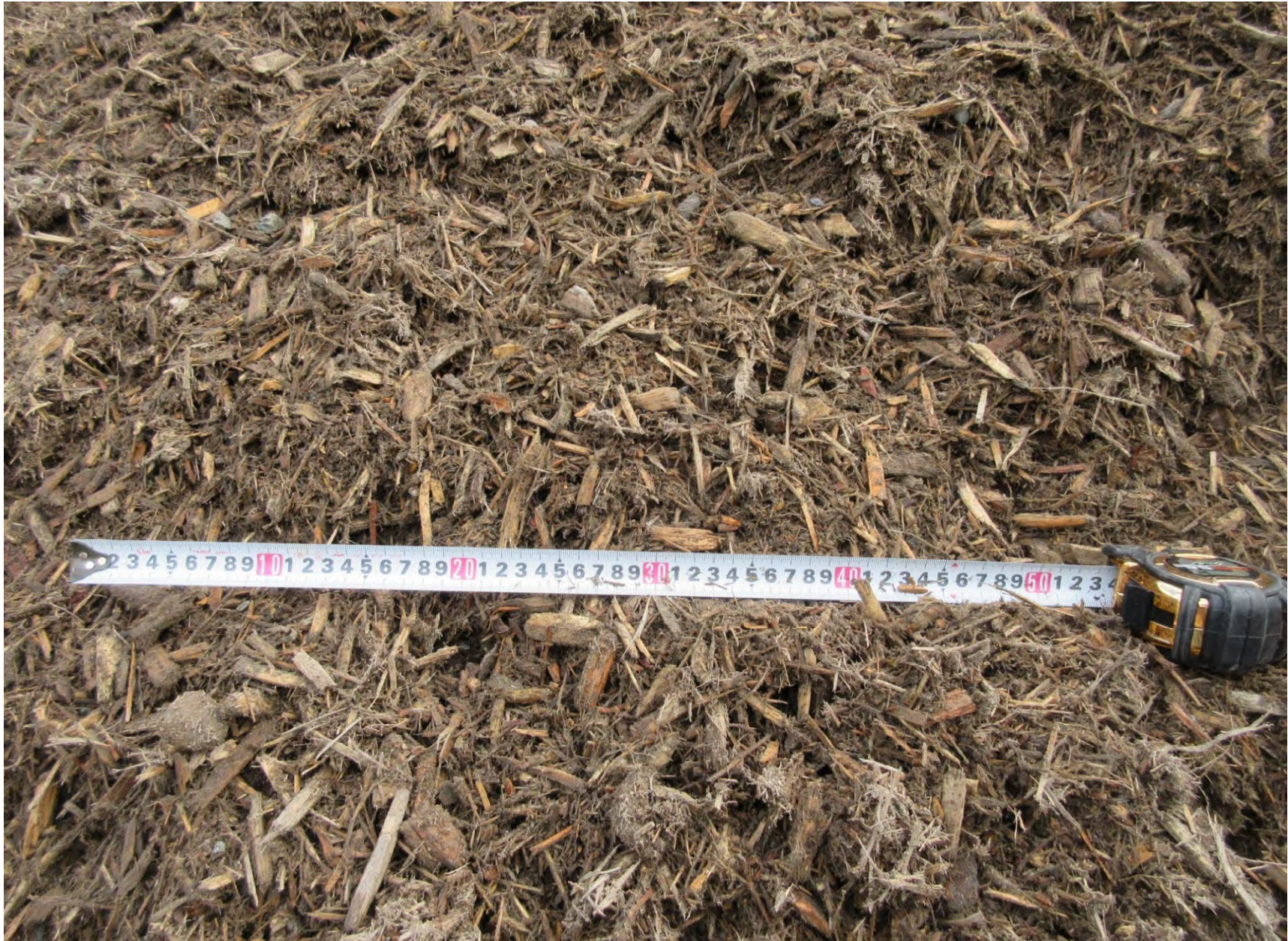
②破碎チップ 幅1～5cm程度 長さ3～10cm程度
