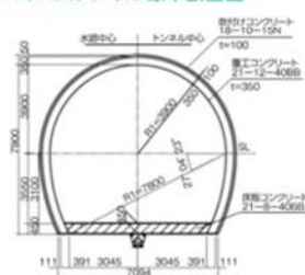
■土砂バイパストンネル標準断面図
