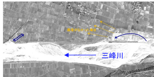
昭和36年6月(三六災害) 三峰川の霞堤により、右岸堤防を越水した洪水を本川に還元した痕跡が残る
