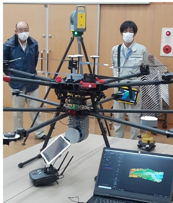
【地上レーザー測量装置、レーザー搭載UAV】
