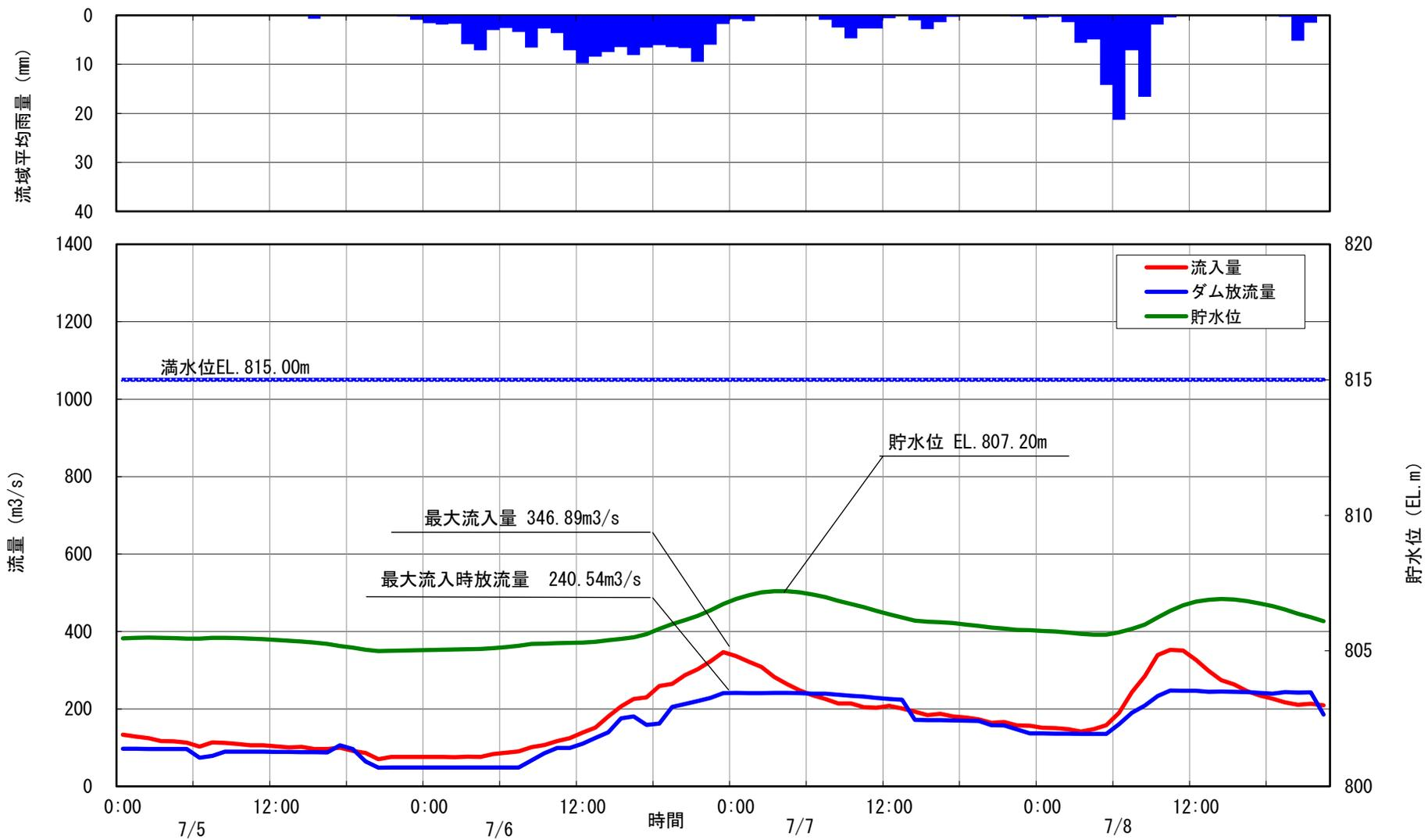
28 美和ダム洪水調節図 令和2年7月6日洪水
