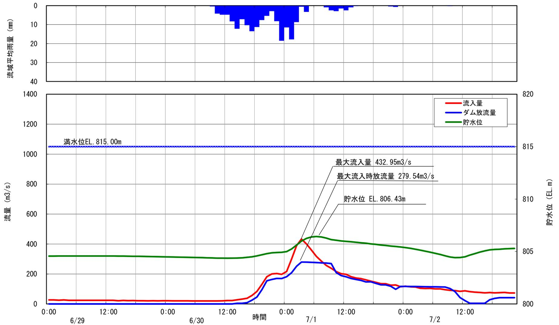
27 美和ダム洪水調節図 令和 2年6月30日洪水
