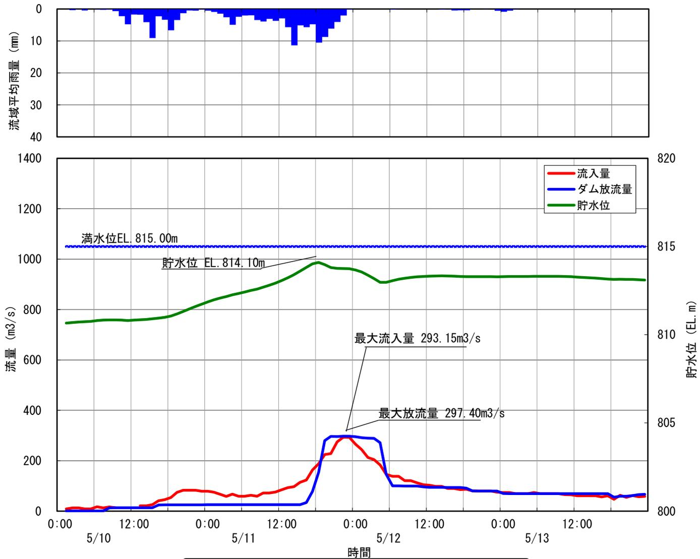
21 美和ダム洪水調節図 平成23年5月11日洪水
