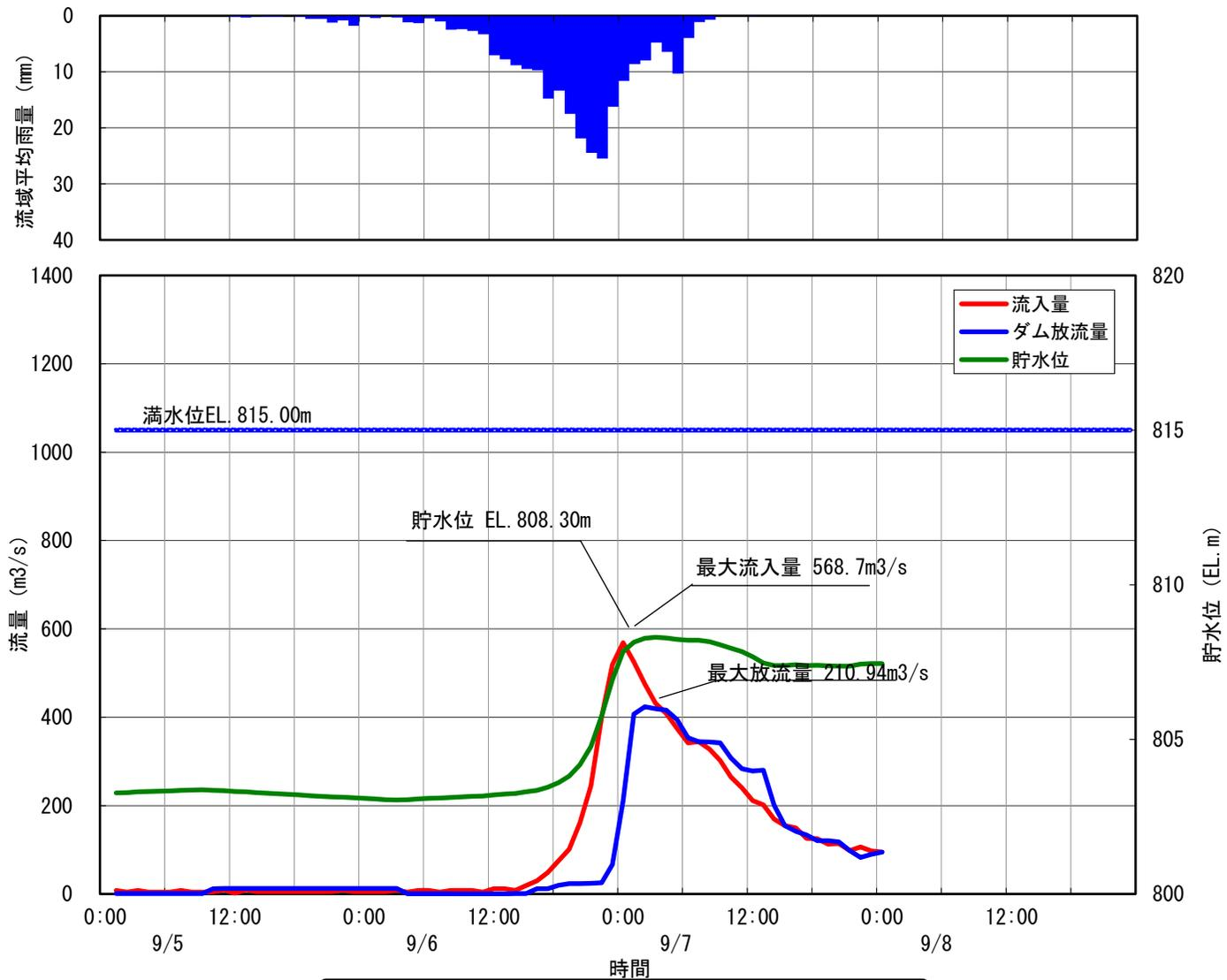
20 美和ダム洪水調節図 平成19年9月6日洪水
