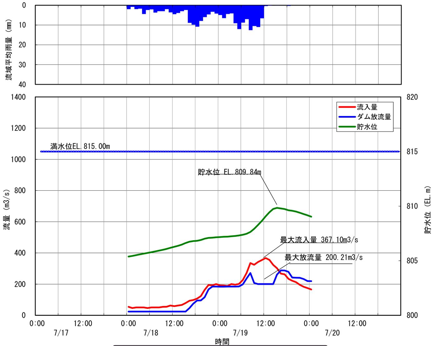
19 美和ダム洪水調節図 平成18年7月19日洪水
