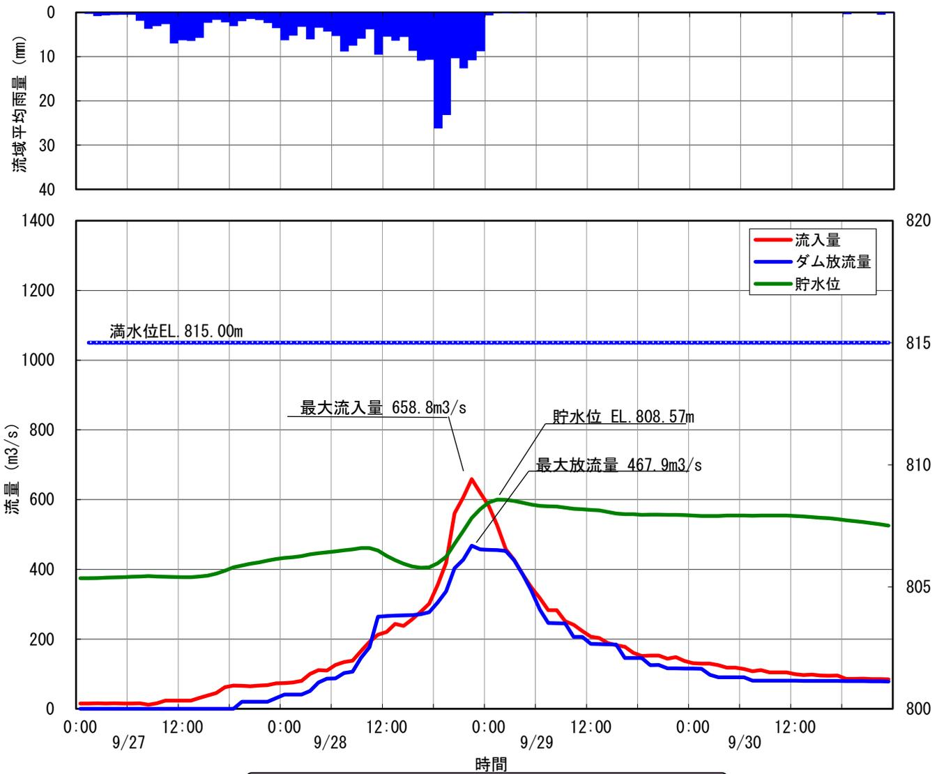
15 美和ダム洪水調節図 昭和58年9月28日洪水
