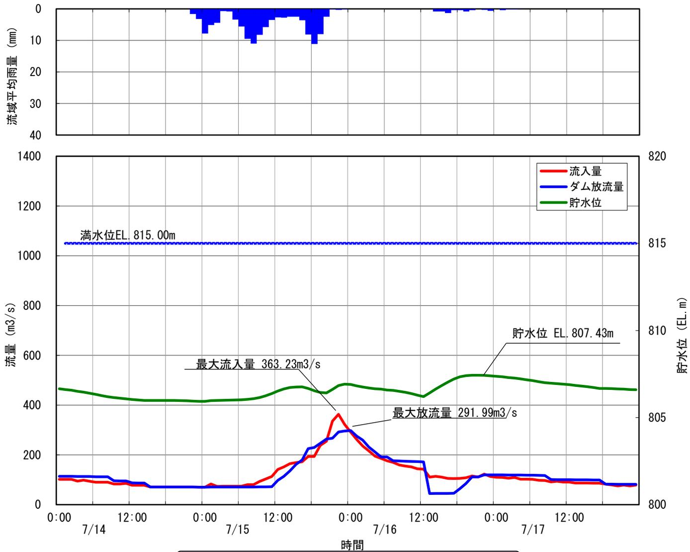
9 美和ダム洪水調節図 昭和47年7月15日洪水
