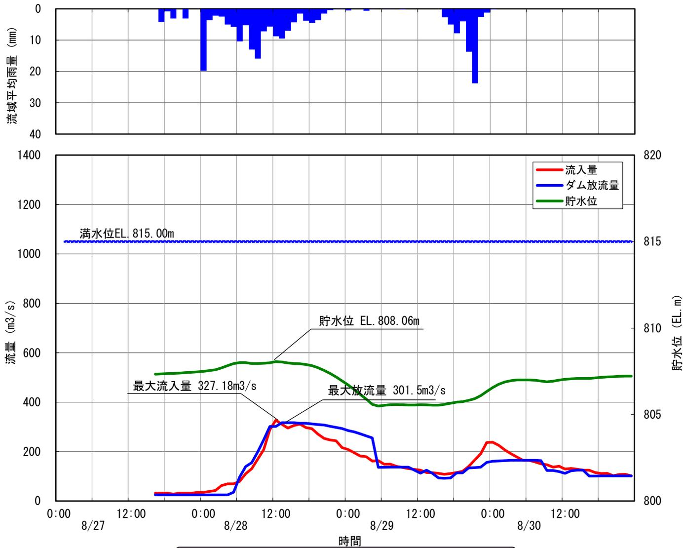
7 美和ダム洪水調節図 昭和43年8月28日洪水
