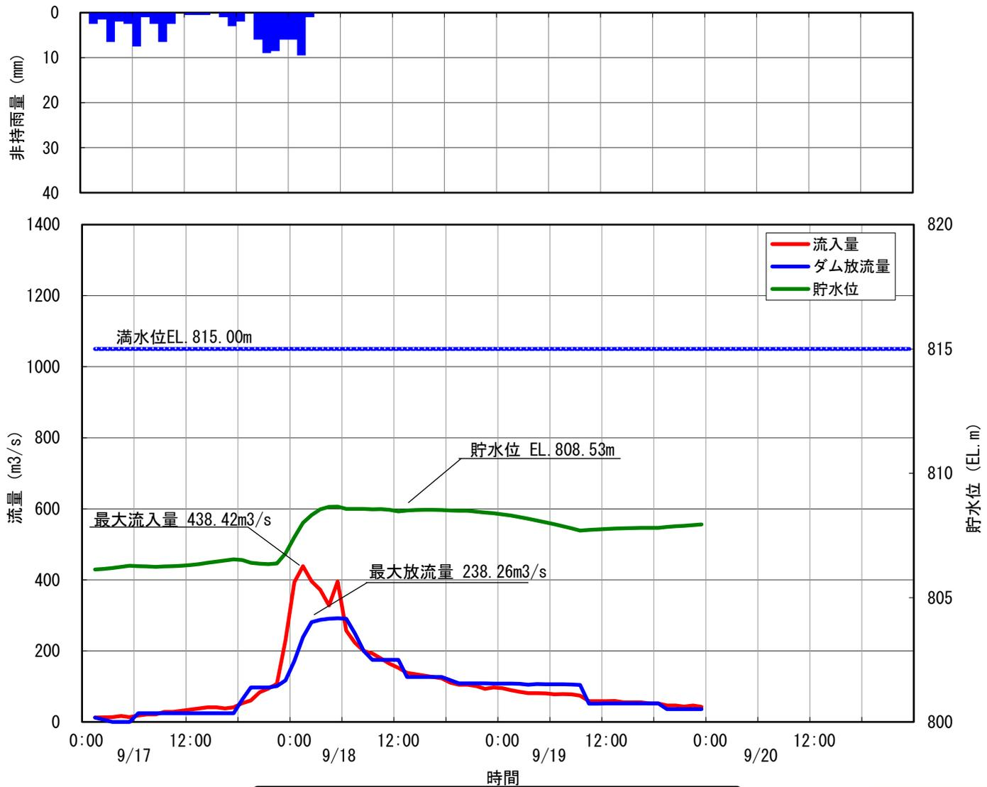
6 美和ダム洪水調節図 昭和40年9月18日洪水
