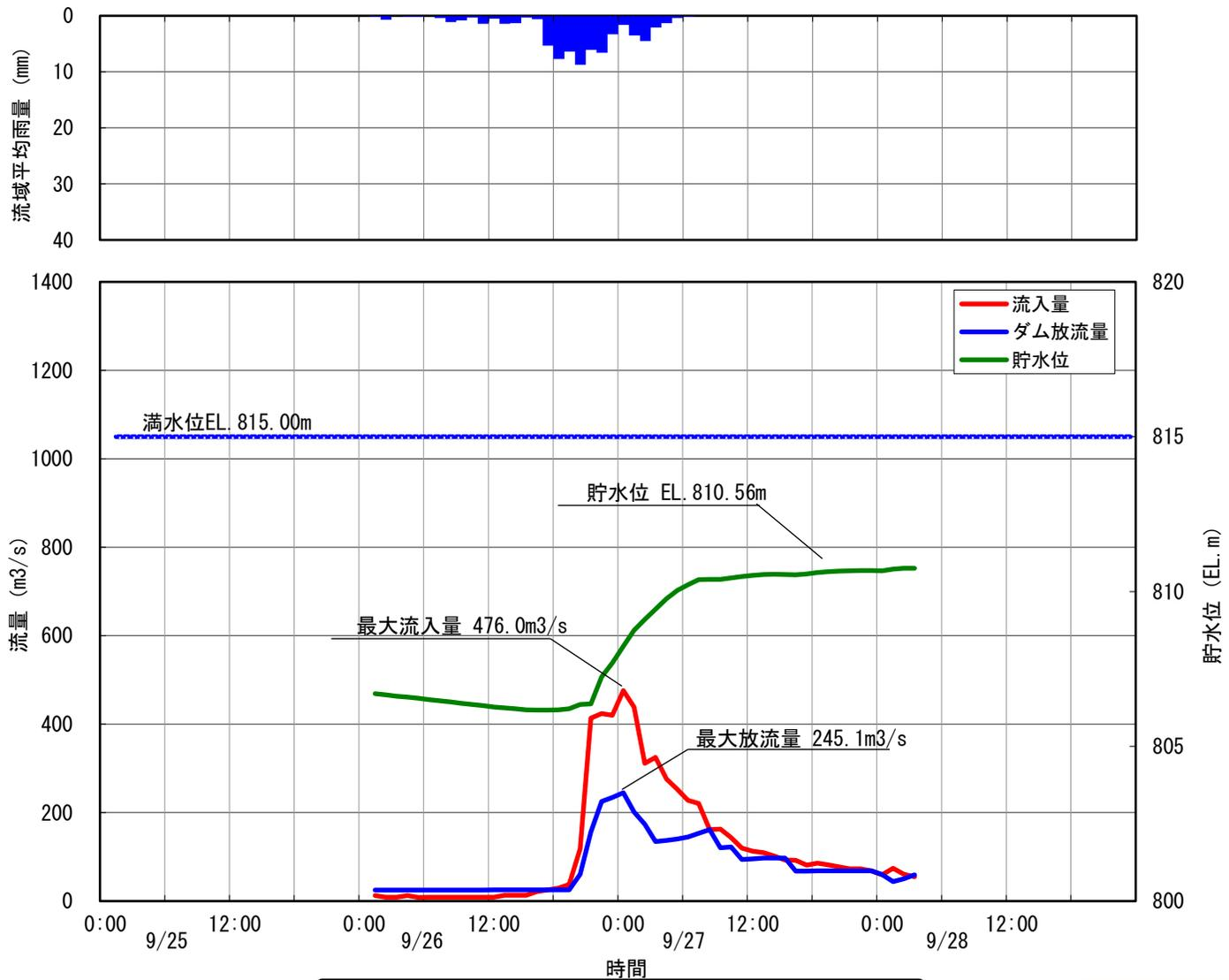
4 美和ダム洪水調節図 昭和34年9月26日洪水
