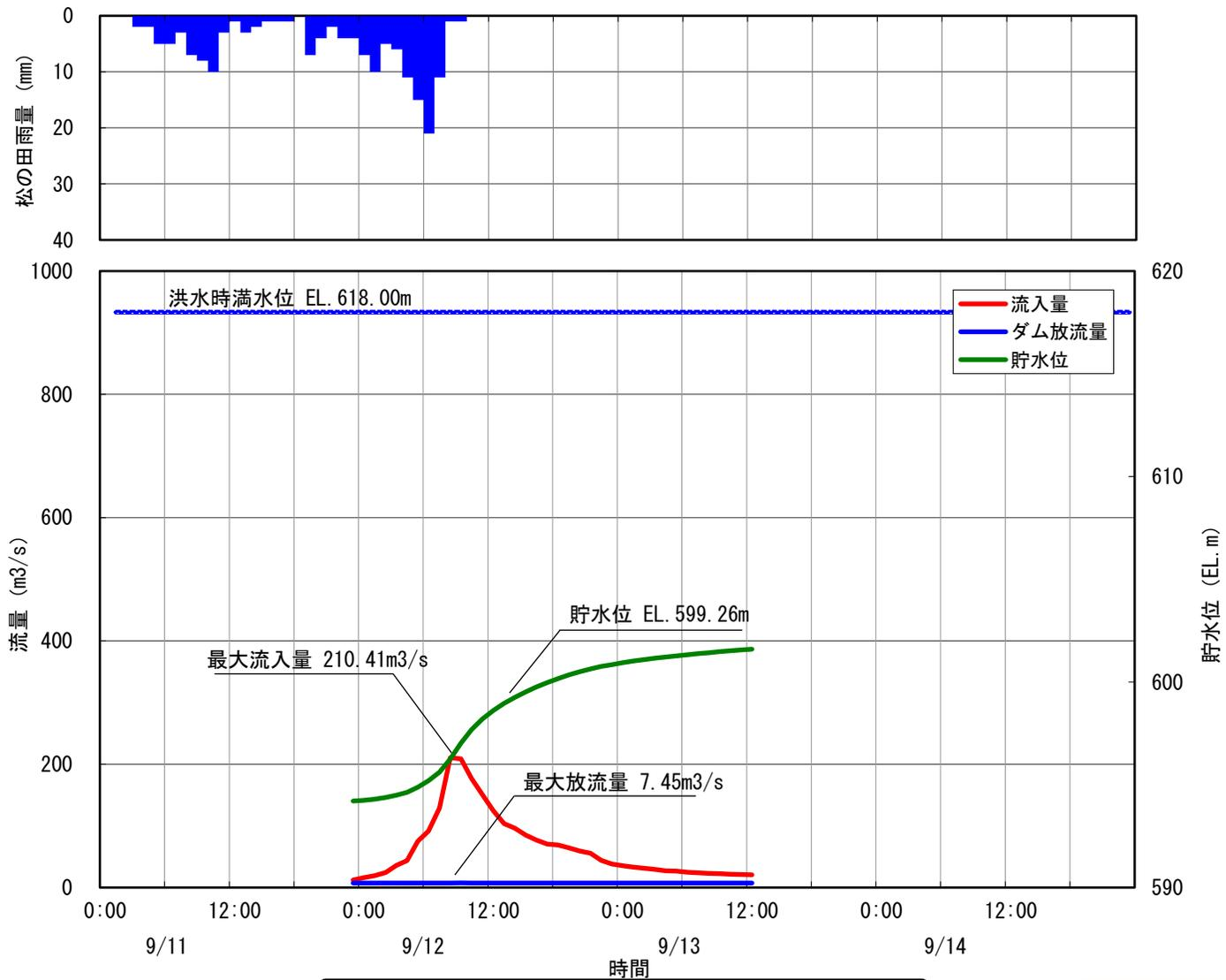
34 小渋ダム洪水調節図 平成12年9月12日洪水
