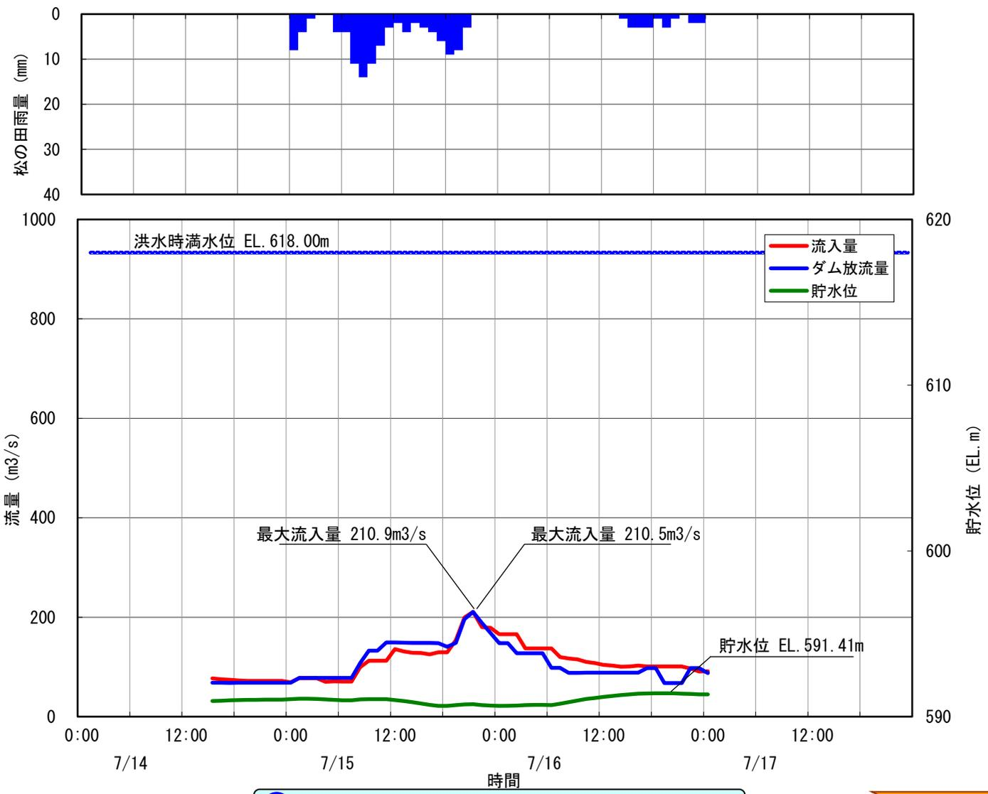
4 小渋ダム洪水調節図 昭和47年7月15日洪水
