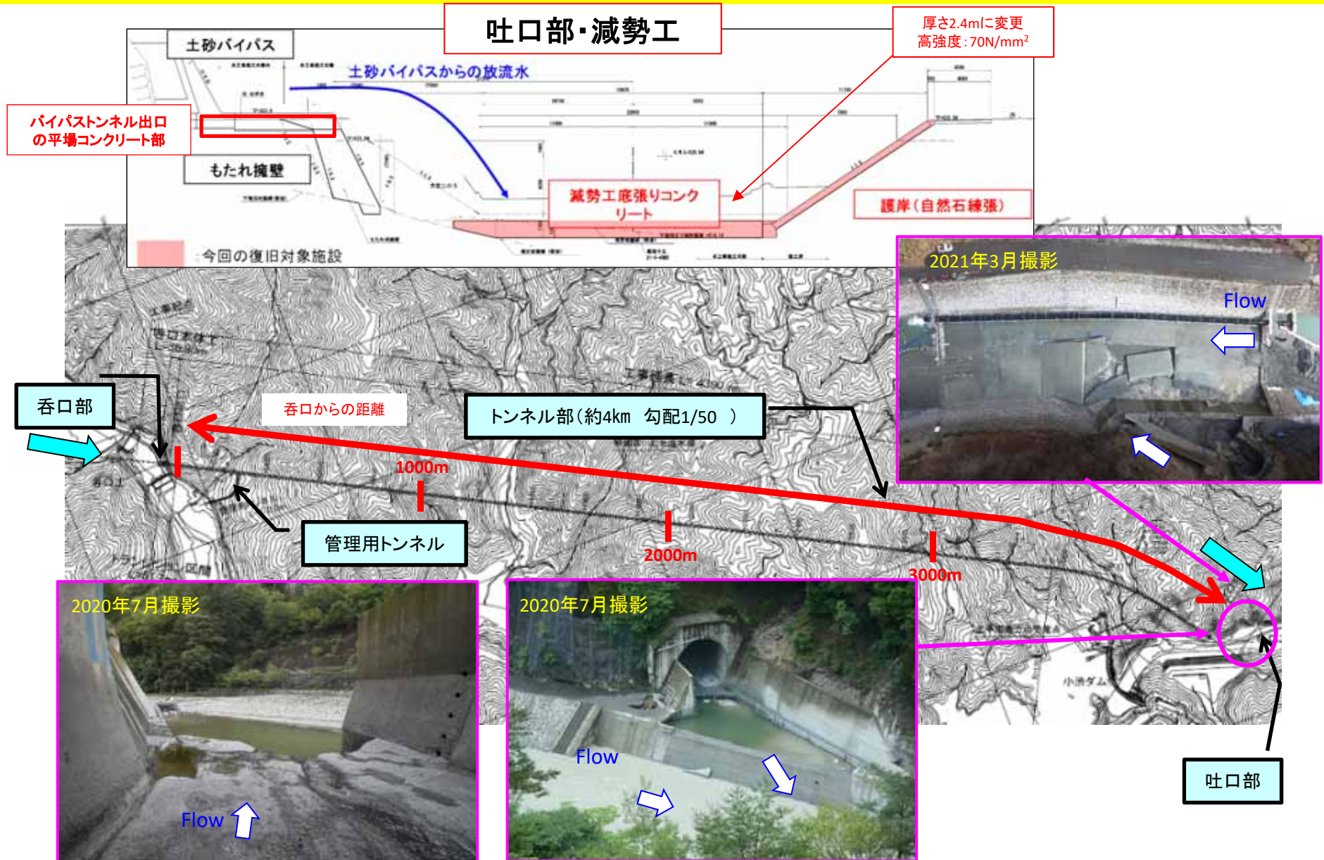
吐口部 トンネル側、上部側からの状況
