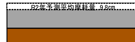
R2.7出水の予測摩耗量 (H30までの実績摩耗量で同定)
