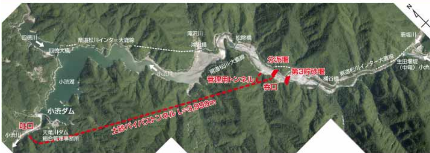
土砂バイパストンネル概要図
