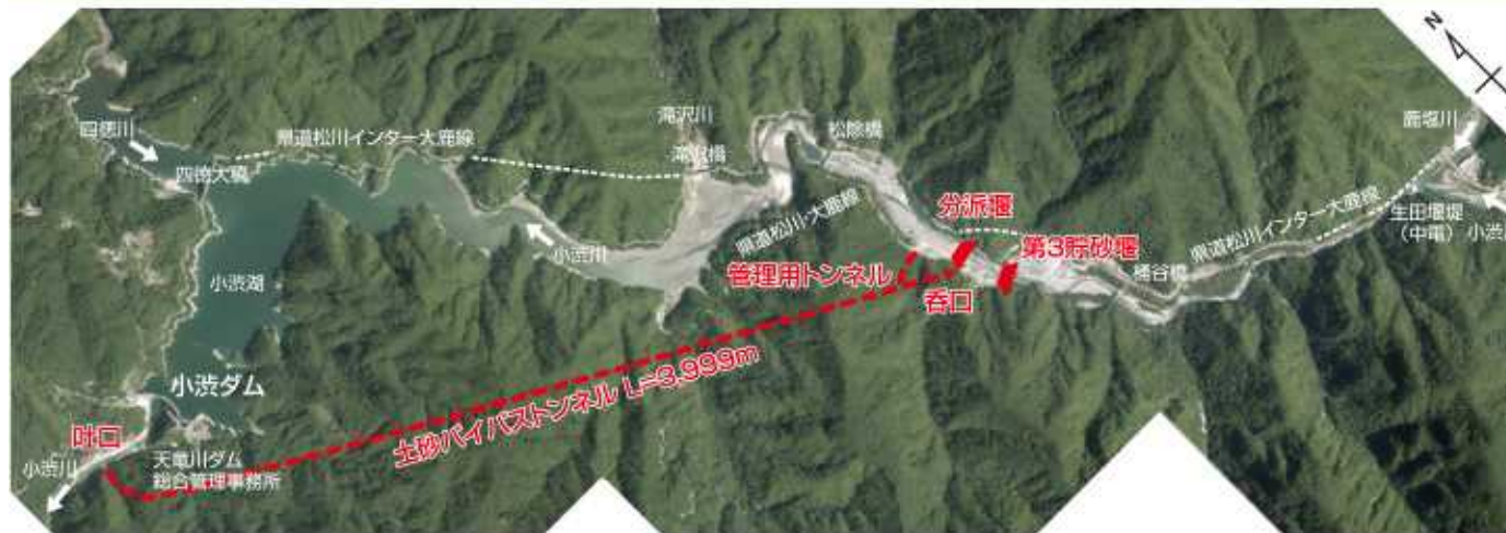
土砂バイパストンネル概要図
