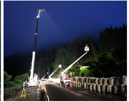
被災現場での夜間復旧作業を支援する照明車
