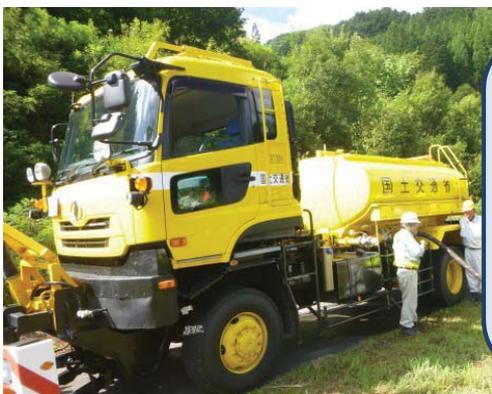
路面清掃用として使用される車両です。緊急時には蛇口を取り付けて給水車として使用することが出来ます。
