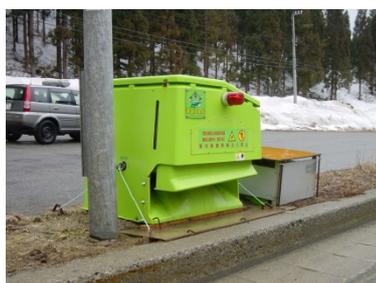
定置式凍結防止剤散布装置
