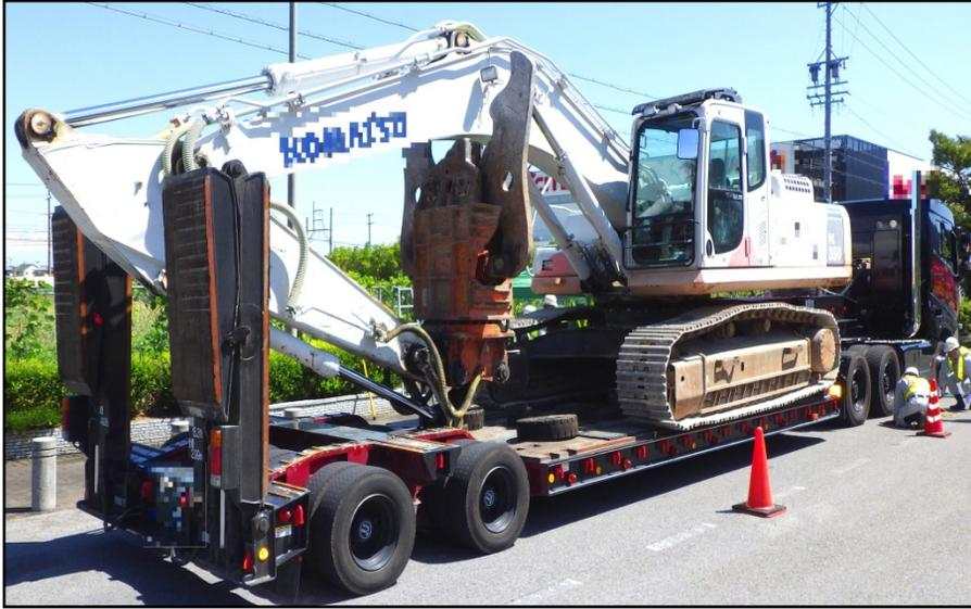
【減載前】重量超過車両の計測状況（総重量約46トン）
