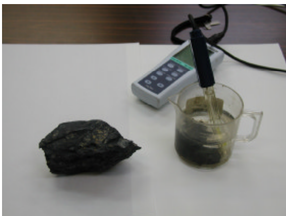
A 試料：風化の進んだ黄鉄鉱を含む粘板岩
