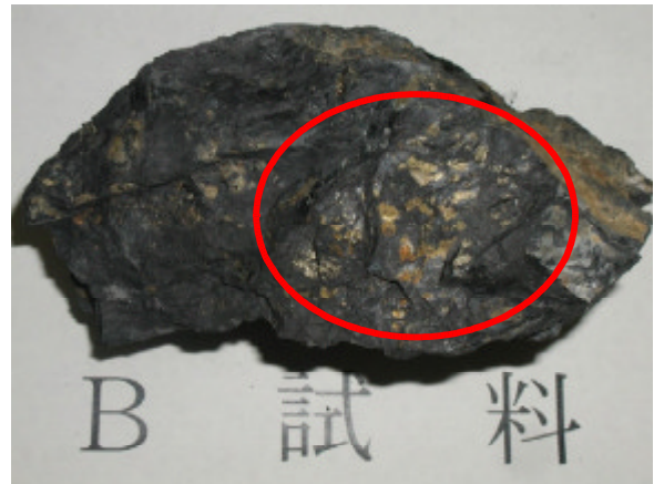
B 試料：結晶度の高い黄鉄鉱を含む粘板岩
