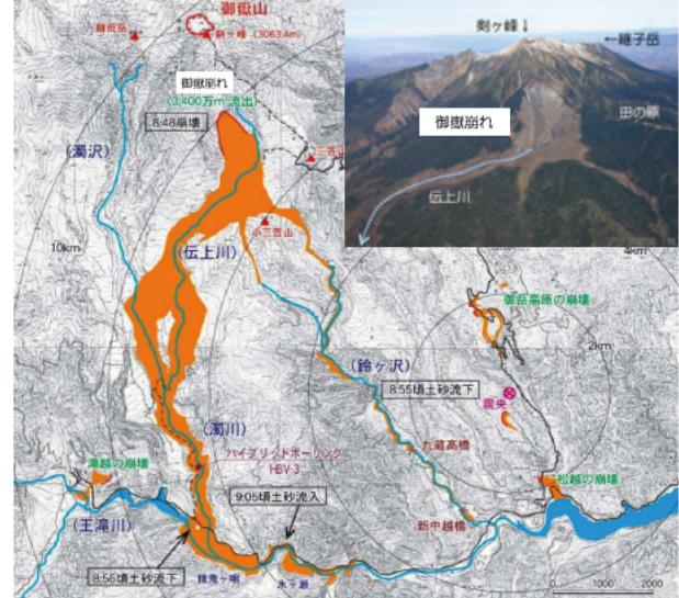
御嶽崩れの崩壊地の位置と土砂の流出状況
