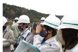
レーザー測距儀による 距離計測
