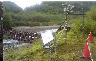
土石流の発生に備えカメラを設置し監視
