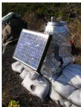
自動降灰・降雨量計による降灰量の監視 (土木研究所; http://www.pwri.go.jp/team/volcano/ash/ash.html )
