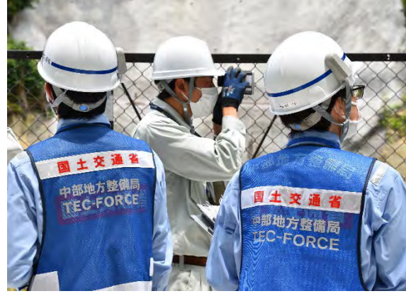
レーザー距離計を用いた点検 (6/20 土岐市:一の洞第2砂防堰堤)
