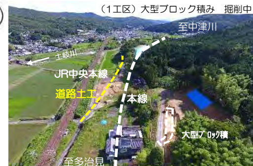
大型ブロック積みの掘削、路体盛土の施工をしています。
