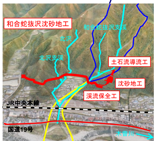
11. 和合蛇抜沢沈砂地工(南木曾町)
