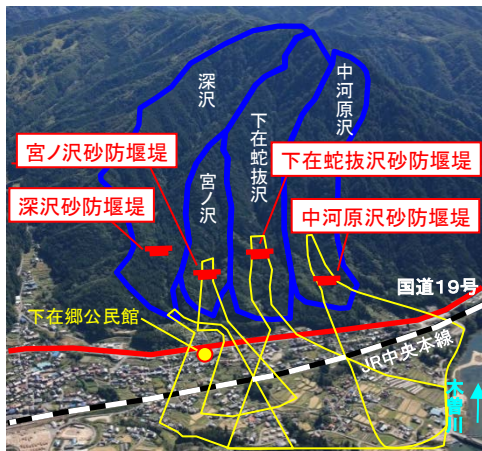
1. 下在砂防堰堤工群(大桑村)
