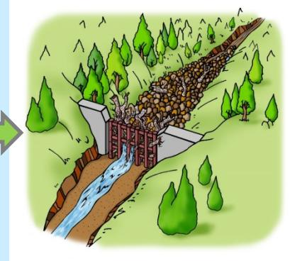
③ 大雨が降り土石流が発生したとき、大きな岩、流木などと一緒に土砂は、堰堤に引っかかり止まります。
