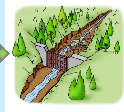
④ 堰堤にたまつた岩、土砂や流木は、次の土石流に備えて取り除きます。
