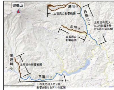
土砂流出による影響範囲のシミュレーション結果
