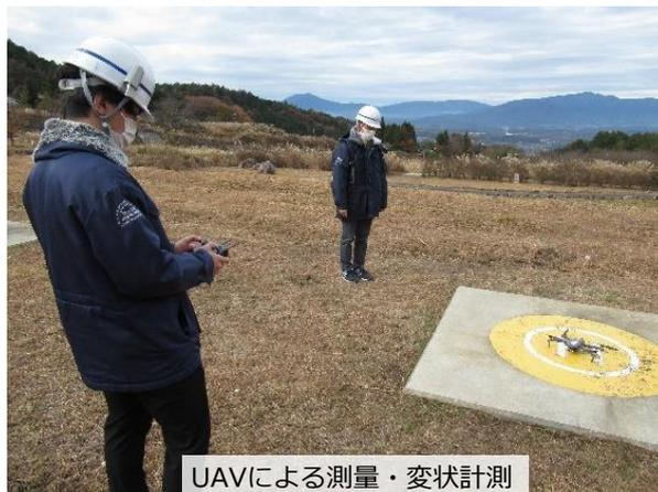
UAVによる測量・変状計測
