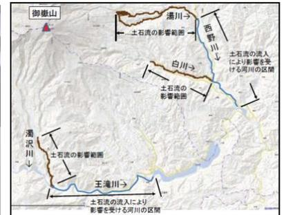
土砂流出による影響範囲のシミュレーション結果
