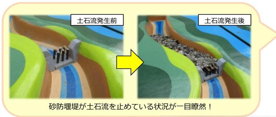
砂防堰堤が土石流を止めている状況が一目瞭然！
