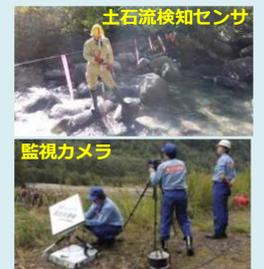
土砂流検知センサ
