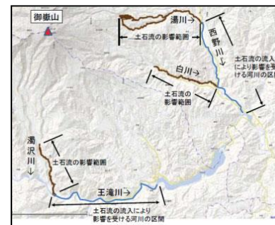
降灰の洪水等による影響範囲のシミュレーション結果
