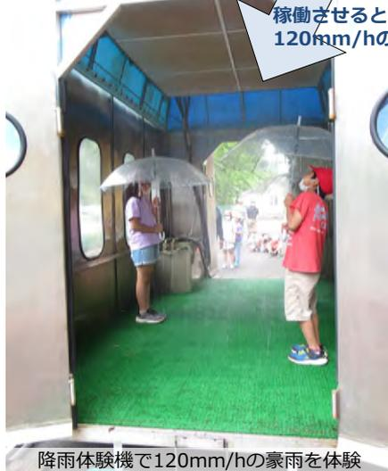
稼働させると120mm/hの雨が降る
