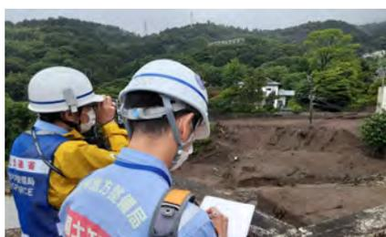
レーザー測距機による計測
