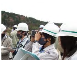
レーザー測距儀による 距離計測
