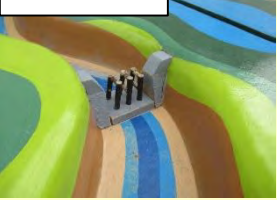
砂防ダムが土石流を止めている状況が分かります
