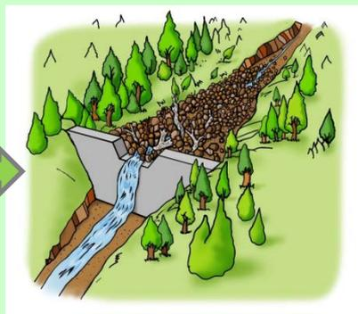
③ 大雨が降り土石流が発生したとき、堰堤は大きな岩や流木などを含む土砂をため、下流への被害を防ぎます。
