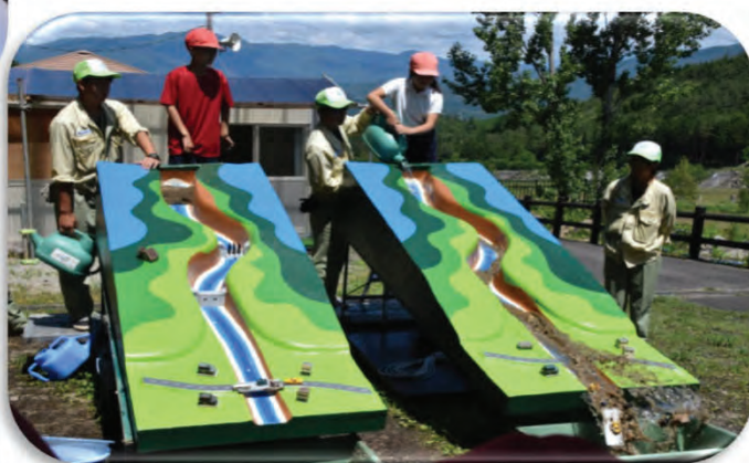
土石流模型実験（砂防施設の効果を学習）
