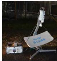
Ku-SAT: 地上通信回線より災害時の影響を受けにくい衛星通信システムを小型軽量化したもの。人間の手で持ち運びが可能。
