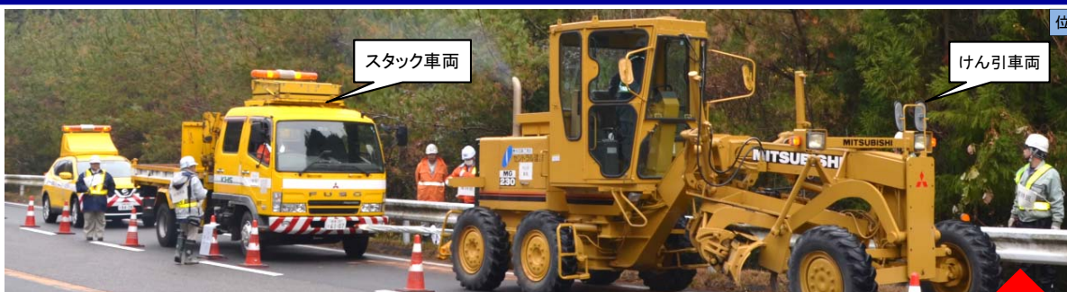
スタック車両移動訓練の様子(けん引車両が真ん中のスタック車両をけん引中)
