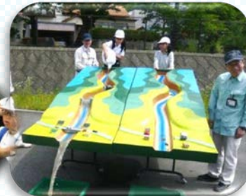
土石流模型 実験で砂防 えん堤の はたらきに ついて学習 しました
