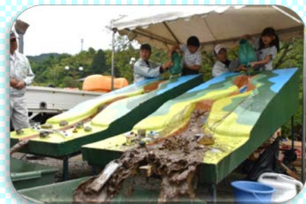
土石流模型実験で砂防えん堤のはたらきについて学びました
