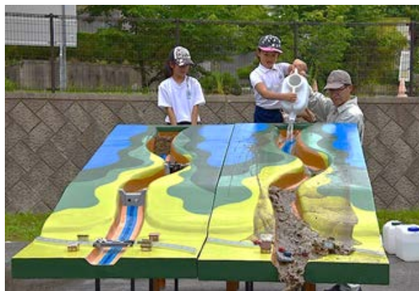
土石流模型実験 (砂防施設の効果を学習)
