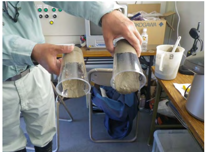
充填材混合試験（A液とB液の混合試験）
