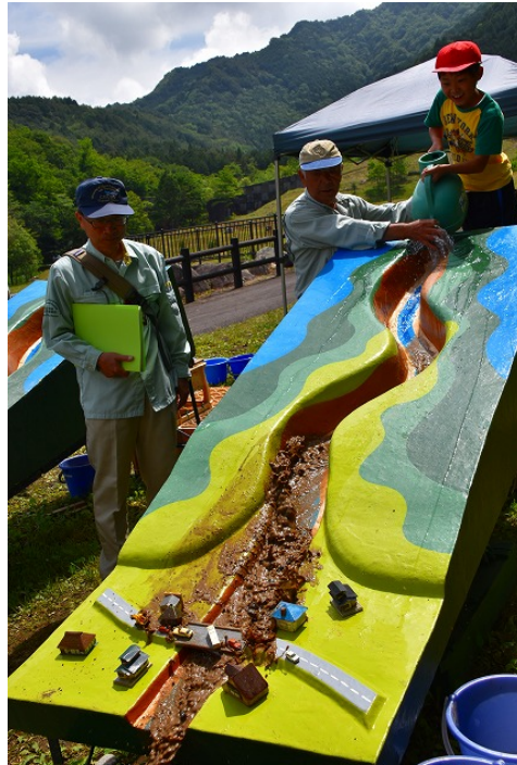
土石流模型実験（砂防施設の効果を学習）
