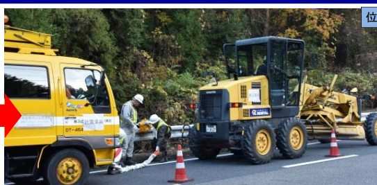
スタック車両とグレーダーに牽引ロープ設置
