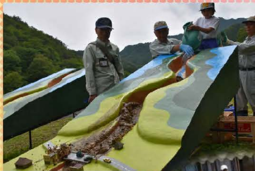
土石流の模型 実験で砂防堰 堤の役割を学 びました
