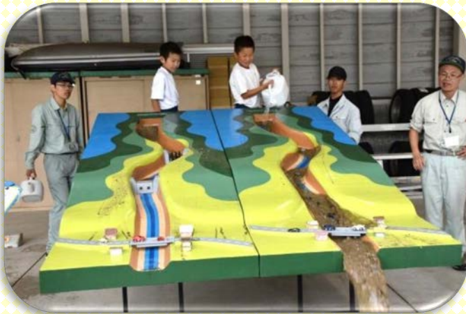
土石流模型実験で砂防堰堤の役割を学びます
